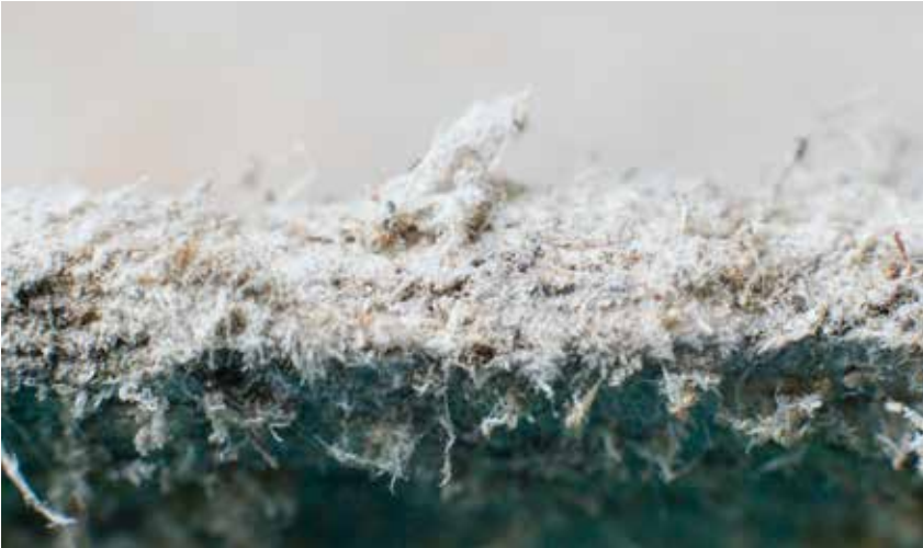
Le CO 2 a aussi un impact sur l'amiante. Suite aux pluies acides, les fibres d'amiante se détachent et se répandent dans l'environnement.
